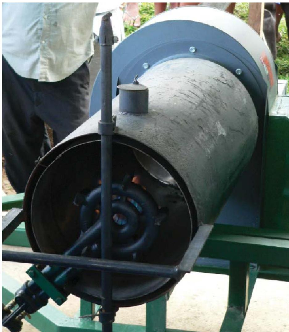
Cilindro generador de calor usando gas natural.
