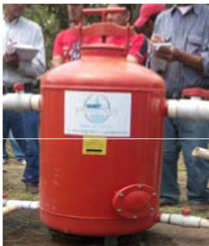
Filtro de arena
