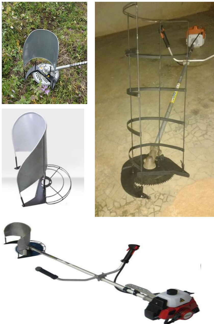
Figura 108. Desbrozadora motorizada adaptada con accesorio, en formato de lengüeta metálica junto con disco de sierra, para el corte de plantas de sésamo en pequeño remajo.
