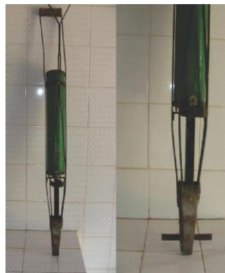
Figura 71. Matraca de marca Krupp usada en sembrar la semilla de ajonjolí, siendo una máquina convencional y otra adaptada con un limitador de profundidad. (Foto: Vicente de Paula Queiroga).
