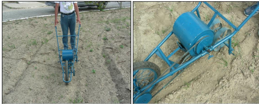
Figura 68. Una sembradora mecánica manual de una hilera desarrollada por Embrapa Algodón para sembrar ajonjolí. Foto: Vicente de Paula Queiroga.
