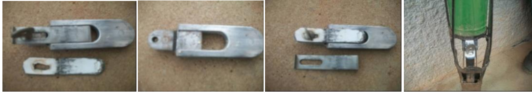
Figura 70. A. Chapa metálica de forma rectangular no regulado y circular al lado; B. Dispensador de la chapa rectangular; C. Chapa metálica de forma circular no regulado y el rectangular de lado; D. Regulador de semillas instalado en la matraca. Foto: Gilvan Tolentino.
