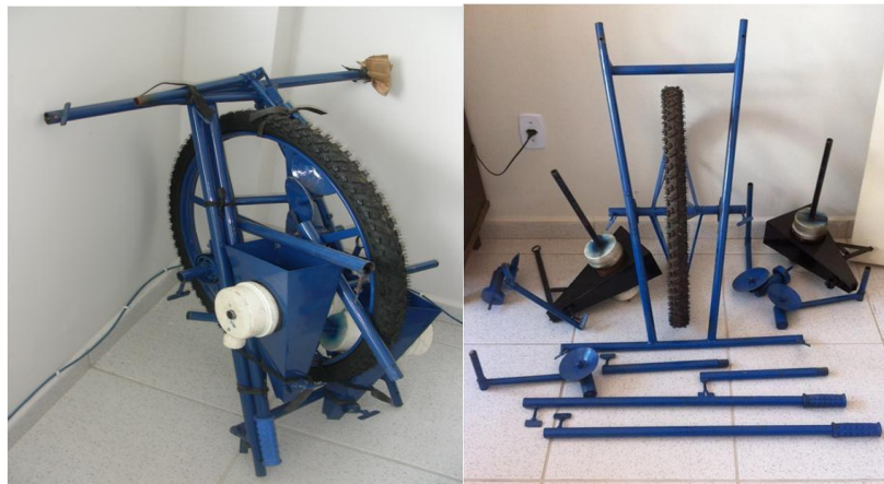
Figura 63. Una sembradora mecánica manual puede ser transportada fácilmente por ser desmontable. Foto: Vicente de Paula Queiroga.
