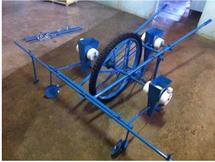
Figura 66. Sembradora mecánica manual (o tracción animal) de tres líneas usada en la siembra de ajonjolí, con distancia de 45 centímetros entre surco. Foto: Vicente de Paula Queiroga.
