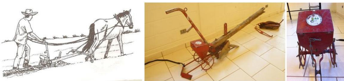
Figura 67. Arado combinado con sembradora de ajonjolí. Fuente: Archivo FOMENTA.
