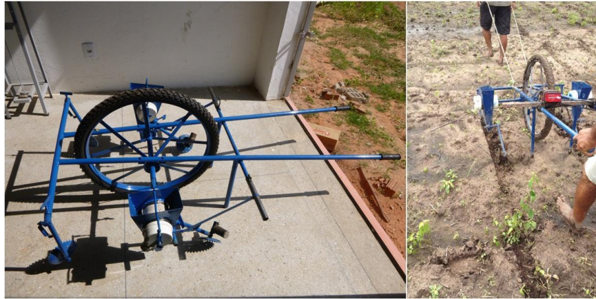
Figura 62. Ruedas de compactación adoptadas en la sembradora de ajonjolí para suelos más pesados, necesita el trabajo de dos operadores. Foto: Vicente de Paula Queiroga.
