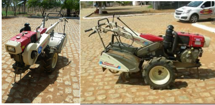
Figura 51. Mini-tractor cultivador utilizado por los productores de São João do Sabugi-RN para preparar el suelo de la labranza de ajonjolí. Fotos: Vicente de Paula Queiroga.
