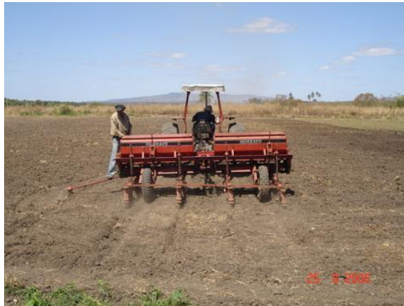
Figura 73. Siembra de semillas de ajonjolí con una sembradora mecánica adaptada en un ensayo de campo en la Estación Experimental da Embrapa de Missão Velha, CE, Brasil. Foto: Tarcísio Marcos de Souza Gondim.
