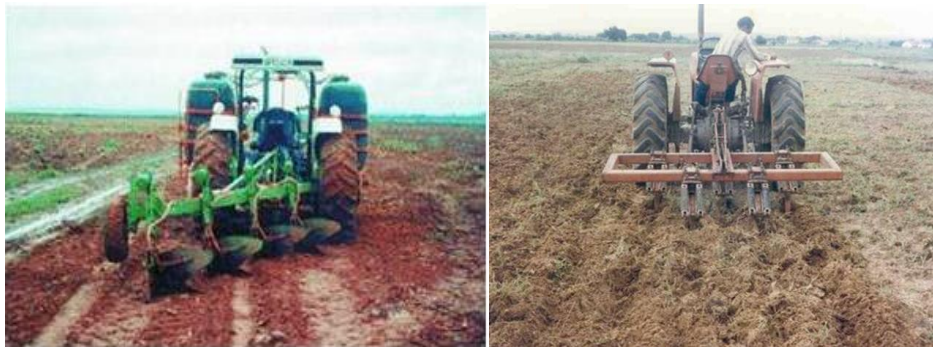
Figura 47. Preparación del suelo con arado de vertedera o arado de cincel. Foto: Odilon Reny Ribeiro Ferreira da Silva.
